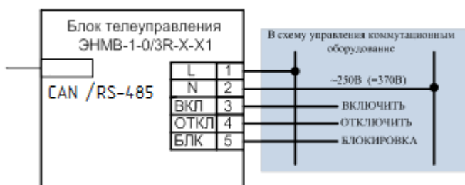
Рисунок 5. Схема подключения цепей питания и телеуправления
