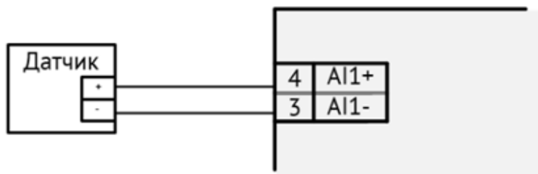
Рисунок 1.22. Подключение активного токового датчика или активного датчика напряжения к ЭНМВ-1.
