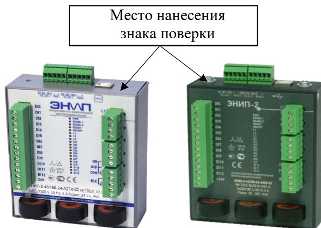
Рисунок 2 – Общий вид преобразователей модификации ЗНИП-2-...-X2
