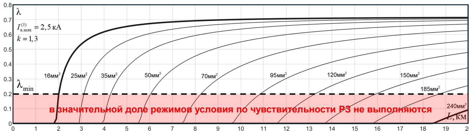
Рис.1 – Относительная зона действия ТО ВЛ 35 кВ
