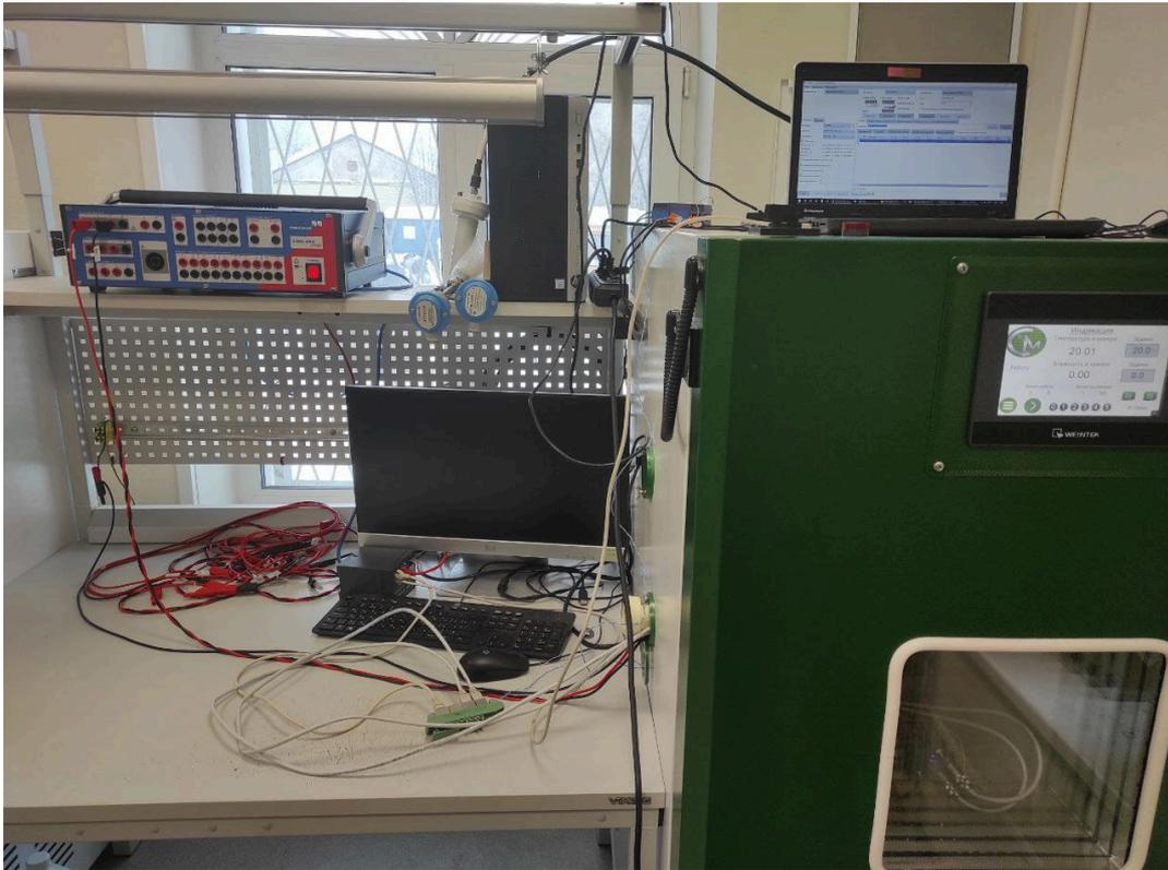
Данная камера имеет диапазон воспроизведения температур от минус 70,5 °С до плюс 100,6 °С с отклонением до  $\pm 1,7$  °С.
